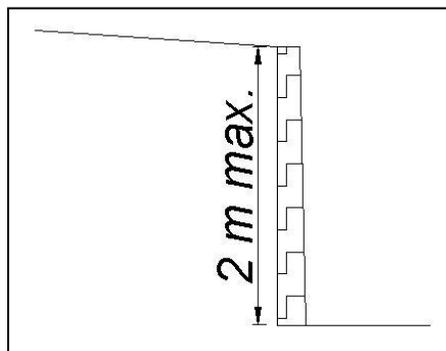
Cependant, lorsque la [construction](#) d'un seul mur de soutènement de 2 mètres de hauteur ne suffit pas, à cause du dénivelé et/ou du remblai projeté, il est permis de construire des murs de soutènement avec paliers. Les paliers doivent avoir une largeur minimale de 4,5 mètres et les murs, une hauteur maximale chacune de 1,5 mètre. L'ensemble des murs doit totaliser une hauteur maximale de 4,5 mètres.
