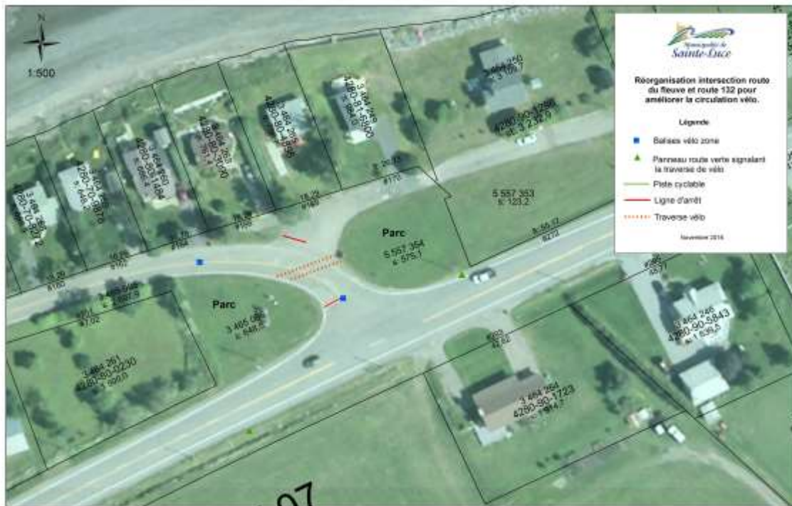
Plan préliminaire d'aménagement d'une traverse-cycliste pour faciliter le virage en U de plusieurs cyclistes
